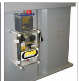
NB1 BOX Nebulizzatore per la lubrificazione lama Sprayer for blade lubrication Micro pulvérisation du ruban
