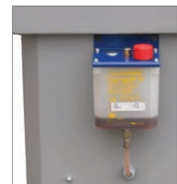
NB1 Nebulizzatore per la lubrificazione lama Sprayer for blade lubrication Micro pulvérisation du ruban
