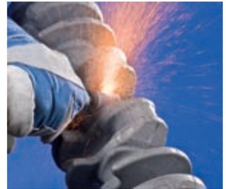
Les meules sur tige spéciales de **dureté R pour fonderies** sont fabriquées à base d'un liant céramique approprié et de carbure de silicium gris.
