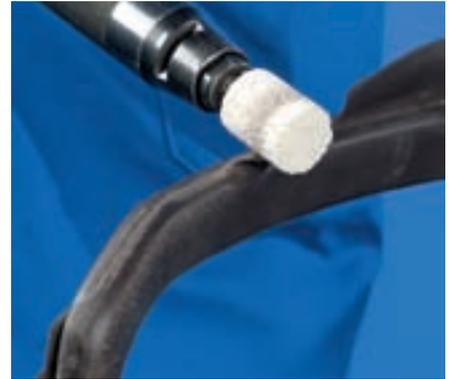
Les meules sur tige de **dureté D** sont fabriquées à base d'un liant céramique spécial et de corindon globulaire (HKK). La faible proportion de liant en combinaison avec le corindon globulaire à fort pouvoir de fragmentation caractérisent le liant de meule sur tige le plus tendre de la gamme PFERD. La dureté D convient particulièrement à une utilisation universelle sur les matériaux tendres comme l'aluminium, le caoutchouc et le bois et se distingue par sa grande facilité d'usinage.
