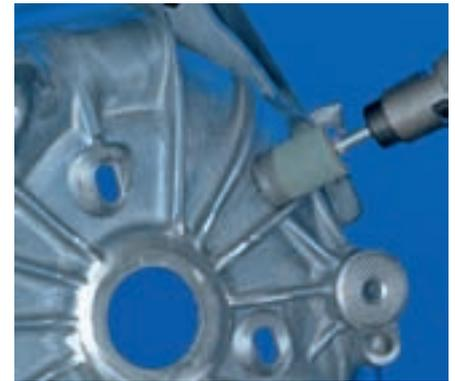
Les meules sur tige de **dureté F-ALU** sont fabriquées à base d'un liant céramique et de carbure de silicium vert. La structure très ouverte et une imprégnation spéciale permettent d'atteindre un volume d'enlèvement très élevé lors de l'usinage de matériaux encrassants. La dureté F-ALU convient particulièrement à une utilisation universelle sur l'aluminium et les métaux non-ferreux et se distingue par sa grande facilité d'usinage et l'enlèvement de matière élevé.
