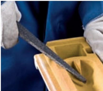
Les segments abrasifs en forme de triangle conviennent tout particulièrement à l'usinage des moules et noyaux de sable dans les fonderies.
