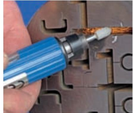
Les meules sur tige de **dureté T** sont fabriquées à base d'un liant céramique et de corindon supérieur blanc. La dureté T fait partie des liants les plus durs pour les meules sur tige de petites dimensions. La solidité extrême du liant permet une durée de vie très élevée. La dureté T convient particulièrement à une utilisation sur les aciers durs.
