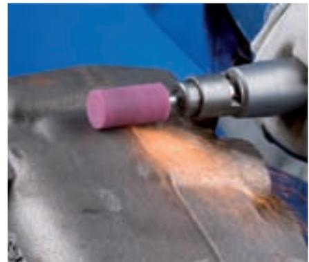
Les meules sur tige spéciales de **dureté O pour fonderies** sont fabriquées à l'aide d'un liant céramique optimisé avec un mélange de grains abrasifs à base de corindon supérieur rose et rouge.
