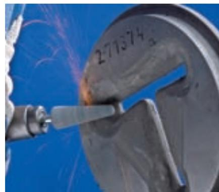
Les meules sur tige de **dureté H** sont fabriquées à l'aide d'un liant céramique avec un mélange de grains abrasifs à base de corindon normal et de corindon supérieur blanc. Grâce au liant relativement tendre, des volumes d'enlèvement importants par unité de temps sont atteints pendant le processus de meulage.
