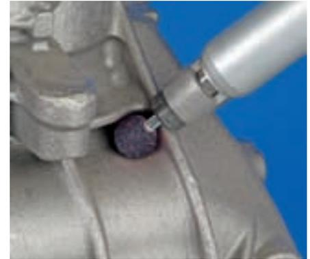
Les meules sur tige de **durété K** sont fabriquées à l'aide d'un liant céramique avec un mélange de grains abrasifs à base de corindon supérieur rose et de corindon normal. Intégrée au liant de durété moyenne, cette combinaison de grains abrasifs permet un bon enlèvement de matière avec une durée de vie élevée. En association avec des vitesses circonférentielles élevées, la durété K convient particulièrement à une utilisation universelle sur l'acier moulé.
