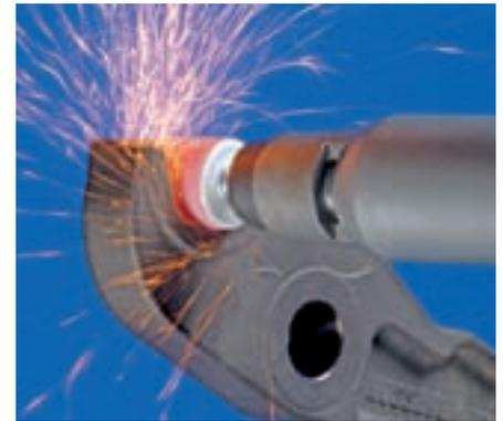
Les meules sur tige de **dureté O** sont fabriquées à base d'un liant céramique et de corindon supérieur rose. Grâce à la combinaison entre les grains très résistants à l'usure et au liant dur, ces meules sur tige présentent une durée de vie très élevée et un bon volume d'enlèvement par unité de temps. La dureté O convient particulièrement à une utilisation dans les angles et aux travaux d'ébarbage sur les ouvrages en acier.
