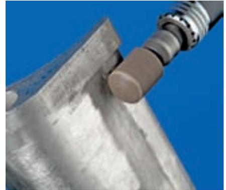
Les meules sur tige de **dureté L** sont fabriquées à l'aide d'un liant de qualité à base de résine synthétique avec un mélange de grains abrasifs de corindon supérieur blanc et rouge foncé.
