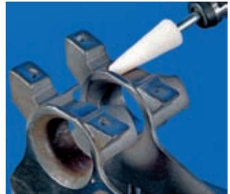
Les meules sur tige de **dureté I** sont fabriquées à base d'un liant céramique et de corindon supérieur blanc. La dureté I est un liant de meule sur tige tendre et procure une très grande facilité de meulage. Ce liant tendre permet d'atteindre des volumes d'enlèvement importants par unité de temps. La dureté I convient particulièrement à une utilisation sur les surfaces en acier dur.
